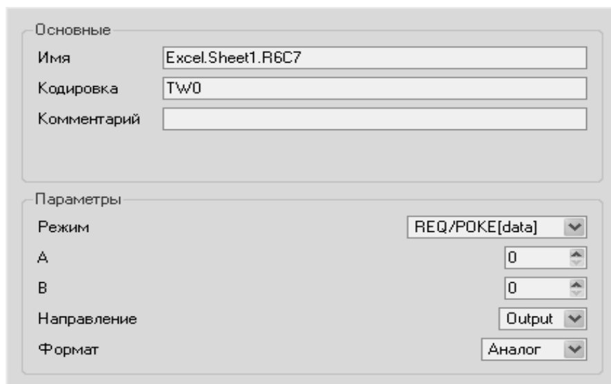
Рис. 2.16. Видеозапись окна настройки DDE обмена между MPB и Excel (режим quest )
