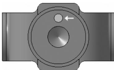
На кольцевой грани, получившейся после создания отверстия, нужно построить небольшую цилиндрическую бобышку так, чтобы она постоянно находилась посередине между внешним и внутренним ребрами грани в вертикальном направлении. Этого можно добиться за счет использования в эскизе переменных и выражений.
