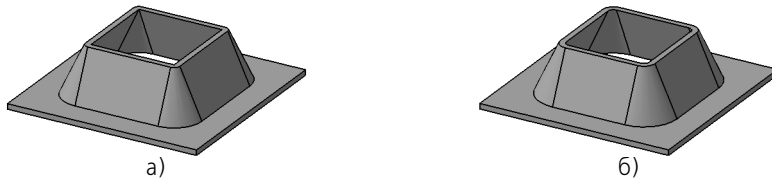
Рис. 112.5. Открытая штамповка с уклоном боковых стенок и скругленными боковыми ребрами: а) радиус скругления равен нулю, б) радиус скругления больше нуля
