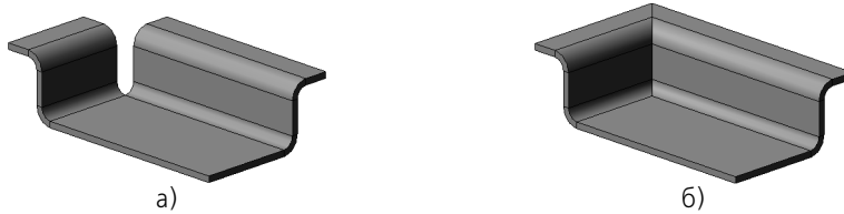
Рис. 108.48. Сгиб вдоль цепочки ребер: а) без замыкания углов, б) с замыканием (один из вариантов)
