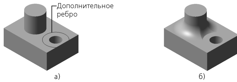
Рис. 115.1. Использование дополнительного ребра: а) исходное состояние детали, б) результат выполнения операции скругления с сохранением кромки
